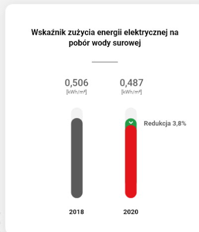
SCHEMAT 24. Porównanie poboru wody i wskaźnika zużycia energii elektrycznej na pobór wody w latach 2013-2020
